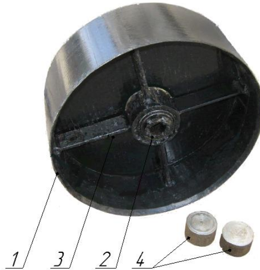
Рис.2. Валок у розрізі із додатковим навантаженням: 1 – обичайка; 2 – маточина; 3 – ребро; 4 – додаткове навантаження
